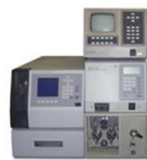
LC-UV Waters (analyse en phase liquide séparation, quantification)
