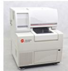
Electrophorèse capillaire (EC) Beckman Coulter (analyse des espèces ioniques, quantification)
